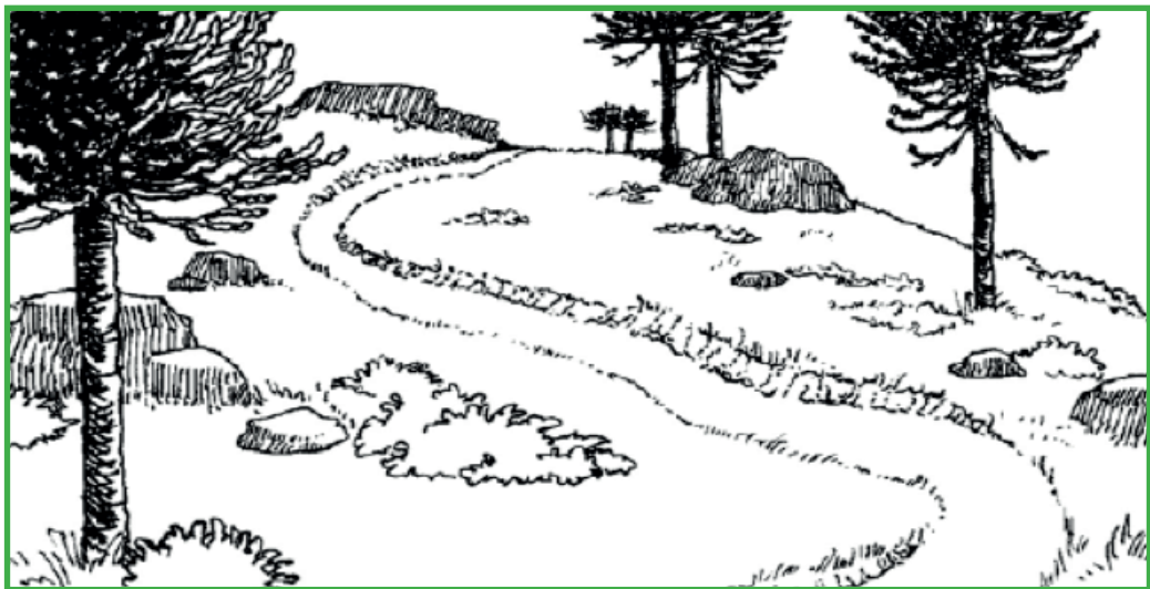
Gráfico 8: Sendero "serpenteante". Las curvas ascendentes son una vía efectiva de ganar en elevación, pero requieren un trazado cuidadoso y no pueden usarse en declives mayores de 20°.
